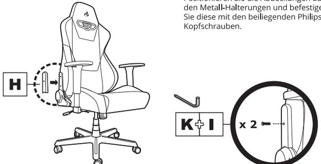
Positionieren Sie die Abdeckungen auf den Metall-Halterungen und befestigen Sie diese mit den beiliegenden Philips Kopfschrauben.
