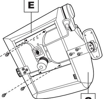
Positionieren Sie die Wippmechanik in korrekter Richtung (Wippmechanikhebel unterhalb der rechten Armlehne). Setzen Sie je einen Federring und eine Unterlegscheibe auf alle vier M8 Schrauben.
