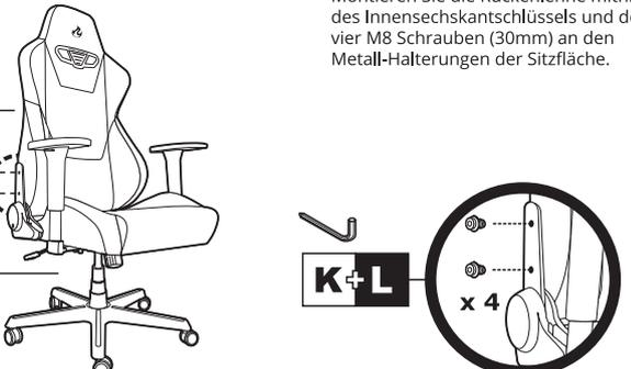
Montieren Sie die Rückenlehne mithilfe des Innensechskantschlüssels und der vier M8 Schrauben (30mm) an den Metall-Halterungen der Sitzfläche.
