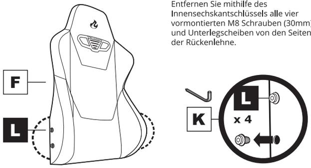
Entfernen Sie mithilfe des Innensechskantschlüssels alle vier vormontierten M8 Schrauben (30mm) und Unterlegscheiben von den Seiten der Rückenlehne.
