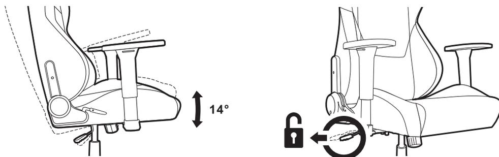
Der zylinderförmige Drehknopf unter der Sitzfläche kann im Uhrzeigersinn gedreht werden, um den Widerstand der Wippmechanik zu erhöhen. Drehen Sie den Knopf gegen den Uhrzeigersinn, um diesen zu verringern. Passen Sie ihn so Ihrem Körpergewicht an.
