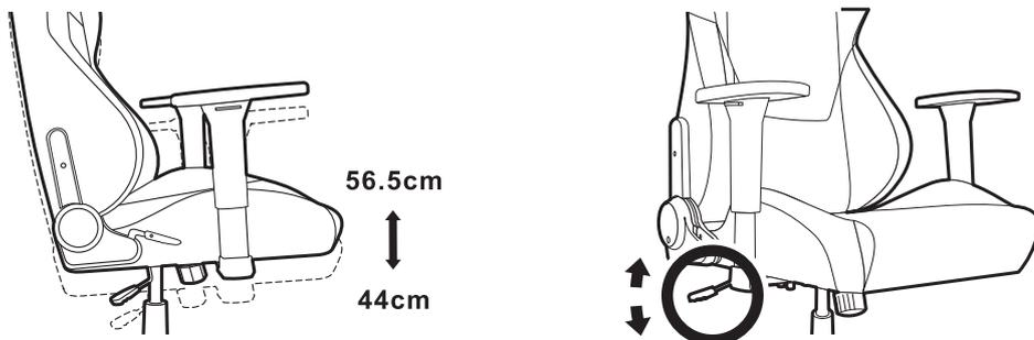
Die Sitzfläche lässt sich um bis zu 14° neigen. Ziehen Sie den rechten Hebel auf der Unterseite der Sitzfläche nach außen, um die Wippfunktion zu entsperren.
