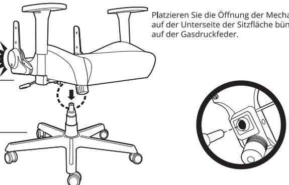
Platzieren Sie die Öffnung der Mechanik auf der Unterseite der Sitzfläche bündig auf der Gasdruckfeder.
